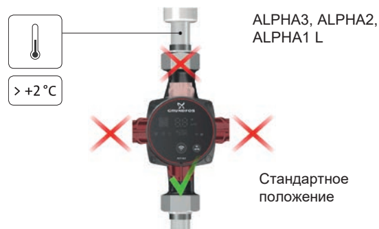
Рис. 17 Возможное положение блока управления для системы отопления
