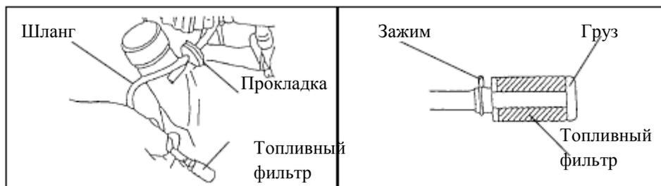
Очистите топливный бак перед установкой топливного фильтра. Повреждённый фильтр подлежит обязательной замене.
