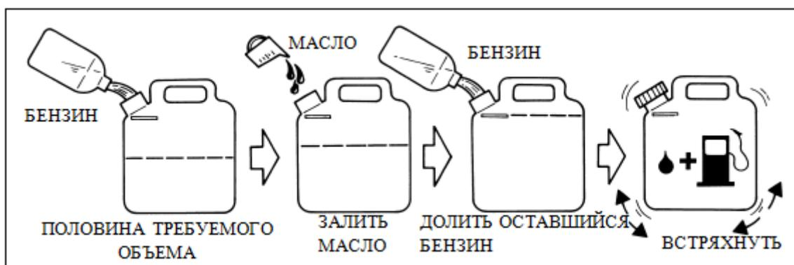
Перед тем, как снимать крышку, очистите участок вокруг горловины бака, чтобы избежать попадания в топливную систему грязи и пыли. Всегда встряхивайте ёмкость с топливной смесью перед заправкой.
